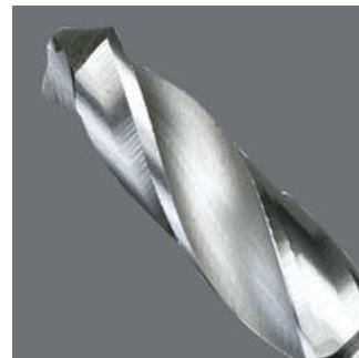
Spiralbohrer-Bit – für Metall-Anwendungen • 1/4"-Antrieb passend für Halter nach DIN 3126-D 6,3 (ISO 1173) • Sehr gute Kraftübertragung durch Sechskant-Schaft • HSS = Hochleistungsschnell-Stahl mit Kreuzanschliff • Fein abgestimmte Material- Elastizität für hohe Standzeiten • Sehr gute Rundlaufgenauigkeit • Zähharte vergütete Bits für besonders lange Lebensdauer
