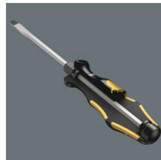
Mit durchgehender Sechkantklinge aus hochwertigem Bits-Material – dadurch verlustfreie Kraftübertragung auch bei Hammerschlägen. Das zähhart vergütete Material verhindert Absplittern oder Bruch der Klinge.
