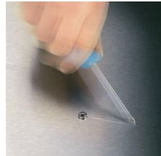
Immer wieder passiert es, dass man beim Verschrauben aus der Schraube rutscht. Manchmal werden dabei wertvolle Oberflächen beschädigt oder man verletzt sich sogar. Die Spitze von Wera Lasertip-Schraubendrehern wird mit Laserstrahlen mikroskopisch fein aufgeraut. Diese raue Oberfläche „beißt“ sich förmlich im Schraubenkopf fest. Das unbeabsichtigte Herausrutschen kann damit vermieden werden.
