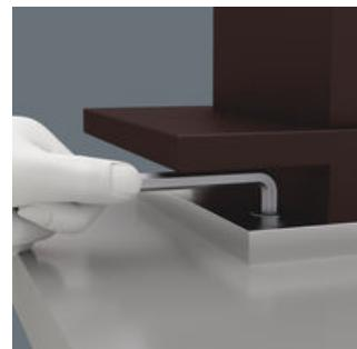
Jeder Anwender kennt seine Winkelschlüssel mit selbst abgesägten bzw. abgeschliffenen kurzen Schenkeln für besonders engste Verschraubungsfälle. Diese haben den Nachteil, dass sie zum einen keinen Korrosionsschutz mehr an der Trennstelle aufweisen und zum anderen ggf. durch zu hohe Temperaturen beim Trennen „weich“ und unbrauchbar geworden sind.
