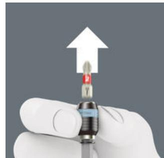
Zum Bitwechsel einfach die Hülse nach vorne schieben: Dabei hebt der Federmechanismus den Bit vom Magneten ab und entriegelt das Werkzeug. Der Bit kann problemlos entnommen werden. Besonders hilfreich: Mühllose Entnahme auch kleinster Bitgrößen ohne Hilfswerkzeug.
