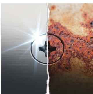
Durch den Einsatz von Edelstahl-Bits wird die Entstehung von Rost auf Edelstahl-Schrauben oder Edelstahl-Oberflächen vermieden. Fremdrost auf Edelstahl entsteht vorwiegend durch Abrieb beim Verschrauben mit herkömmlichen Stahlwerkzeugen. Der Abrieb hinterlässt festhaftende Stahlpertikel, die unter Einwirkung von Sauerstoff zu Rost werden.
