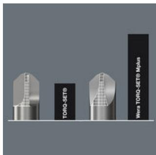
Das von Wera entwickelte Mplus Profil weist gegenüber Werkzeugen mit dem konventionellen TORQ-SET® Profil stärkere Flanken auf. Dadurch ergibt sich ein wesentlich höheres Bruchdrehmoment und eine vielfach längere Lebensdauer des Wera TORQ-SET® Mplus Werkzeugs.
