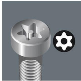
Konstruiert, um unerlaubtes Lösen von sogenannten Sicherheitsverschraubungen zu verhindern. Um eine Verwendung „normaler“ TORX®-Werkzeuge nicht zuzulassen, besitzen die Schrauben in ihrem Antriebsprofil einen vorstehenden Zapfen. Dieser wird in der Bohrung der TORX® B0 Werkzeuge aufgenommen und die Sicherheitsverschraubung kann gelöst werden.
