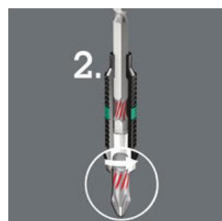
Größere Belastungsspitzen werden durch die Torsionswirkung des Bitschaftes minimiert (Phase 2). Diese Wirkung wird durch eine gezielte Sonderwärmebehandlung nach dem Härtprozess des Bits erzielt. Dadurch wird die Härte des Schafes gegenüber der Abtriebsspitze reduziert.
