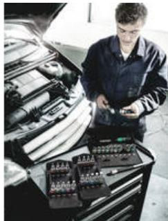
**Steckschlüsselleinsatz mit Haltefunktion für Außensechskant-Schrauben**
