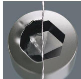
Innensechskantschrauben sind problematisch, denn die Anlageflächen, über die die Kraft vom Werkzeug auf die Schraube übertragen wird, sind sehr schmal. Die Folge: Der Schraubenkopf kann zerstört werden. Hex-Plus Werkzeuge haben größere Anlageflächen, die diese Gefahr verringern. Gut zu wissen: Hex-Plus Werkzeuge passen in jede Standard-Innensechskantschraube!
