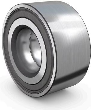
SKF Agri Hubs sind wartungsfreie, abgedichtete Lagereinheiten, die erhebliche Vorteile für Erstausrüster und Endkunden bieten. Da die mit Fett vorgefüllten und abgedichteten SKF Agri Hubs nicht nachgeschmiert werden müssen, reduziert sich das Risiko von Schmierfettspritzern. Durch ihre hohe Steifigkeit verringert sich das Risiko von Scheibenschiefstellungen, was zu einer weiteren Verbesserung der Maschinenzuverlässigkeit beiträgt.
