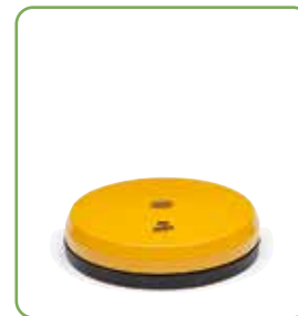
Art. R0529 - Seite R51 Ø 123 • Lackierter Stahl • Max. Belastung 50000 N.
