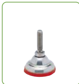
Art. R0383 - Seite R52 Ø 40 • Rostfreier Stahl • Hygienisch • Max. Belastung 7000 N.
