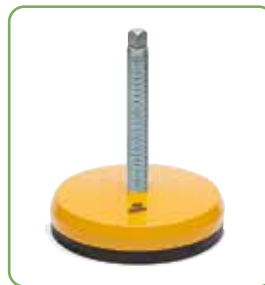
Art. R0406 - Seite R51 Ø 123 • Lackierter Stahl • Max. Belastung 50000 N.
