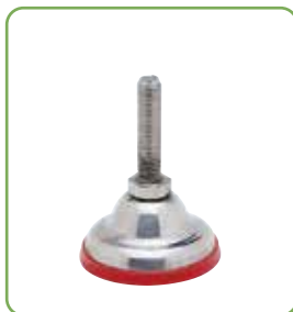
Art. R0384 - Seite R52 Ø 65 • Rostfreier Stahl • Hygienisch • Max. Belastung 12000 N.
