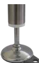
Art. R0751F - Seite R45 Ø 100 • Rostfreier Stahl • Hygienisch • Vorbereitet zur Bodenbefestigung • Max. Belastung 12000 N.
