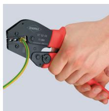
Dritter Schritt: Bei größerem Kraftbedarf z. B. bei isolierten Verbindern 6,00 mm<sup>2</sup> ist auf Grund der längeren Griffe eine Zweihandbedienung möglich
