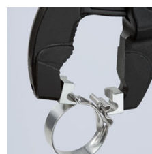
Schließen einer Schlauchschelle mit Anschlag
