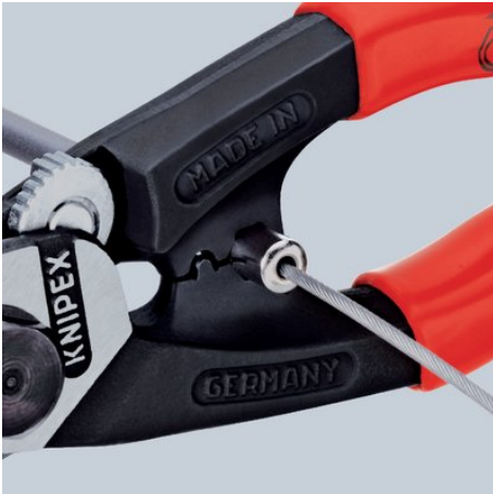
Anpressen der Endhülse an die Bowdenhülle
